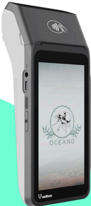
Das V660p ist ein tragbares Hochleistungsgerät mit den neuesten PCI-Sicherheitszulassungen, einem robusten Prozessor und dem zukunftssicheren Betriebssystem Android, das sich vor allem für den Einsatz von Business Applikationen eignet. Die Einsatzbereiche dieses Kraftpaketes gehen deshalb über die reine Zahlungskzeptanz hinaus.
