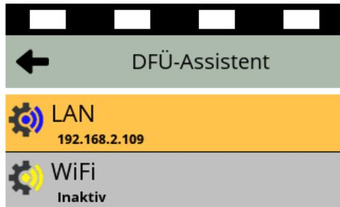
Ist das Terminal mittels Netzwerkkabel verbunden, wählen Sie bitte die Schnittstelle „LAN“ aus.
